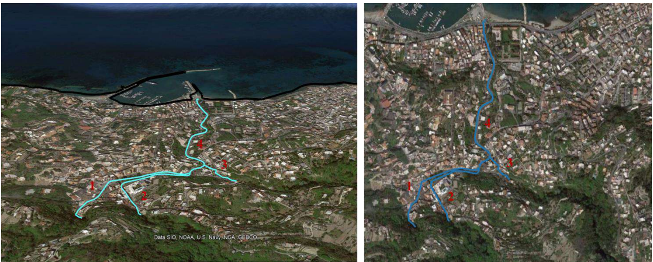
Figura 3.8.2 - Inquadramento satellitare dei tratti tombati costituenti la rete di drenaggio urbana del comune di Casamicciola Terme
