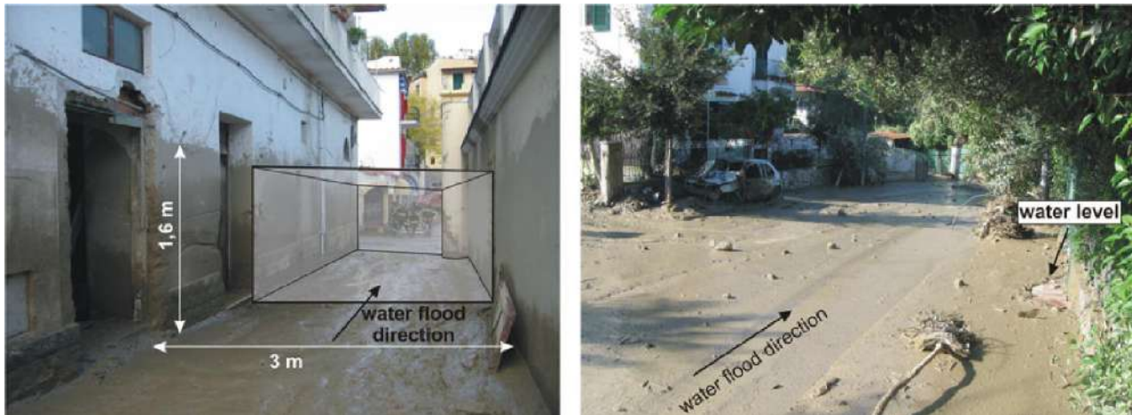
Figura 2.3.5 - Valori dei tiranti idrici a monte di Piazza Bagni e lungo via della Misericordia (Santo et al., 2012).
