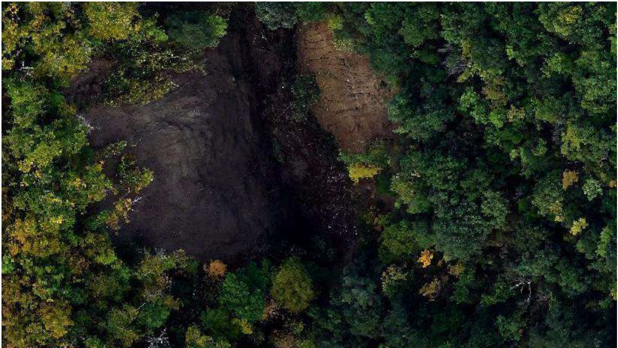
P_3_F. Ortofoto che evidenzia materiale derivante da fenomeni di scorrimento superficiale lungo i pendii e accumulato sul fondo dell'alveo. Lo scorrimento lungo gli alvei si compone di terre, rocce e materiale ligneo oltre ad una certa componente organica.
