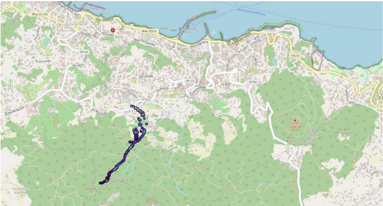
Figura 4.3.14a – Simulazioni relative al bac_cuc_1a, Scenario_A – Colata rapida
