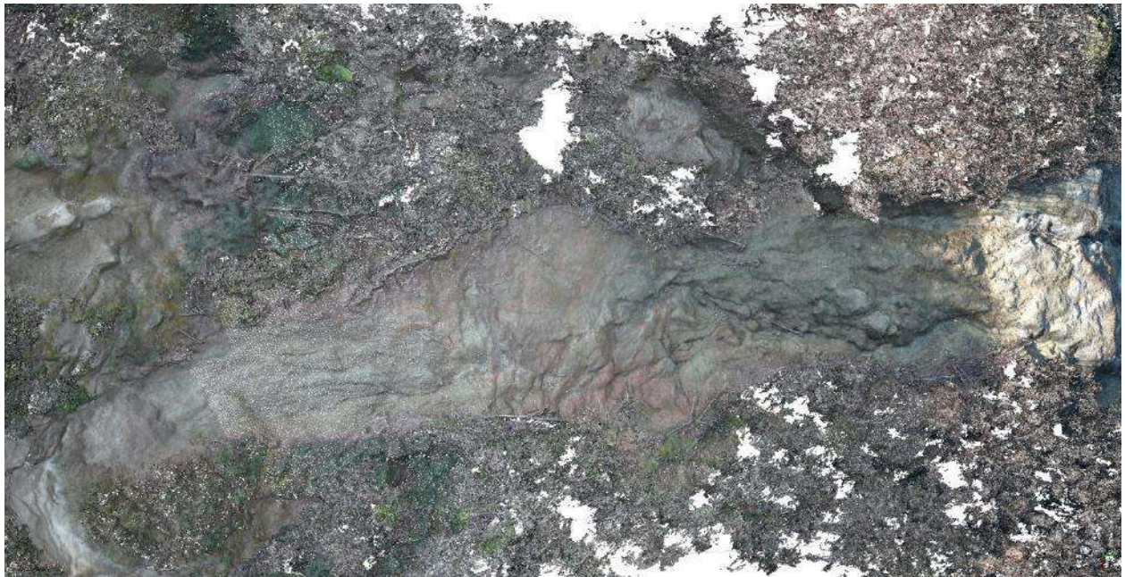
Figura 5.1.2. Nuvola di punti derivata dall'elaborazione fotogrammetrica delle immagini acquisite attraverso aeromobile a pilotaggio remoto: prospettiva nadirale sull'area di distacco della frana principale in località Celario.
