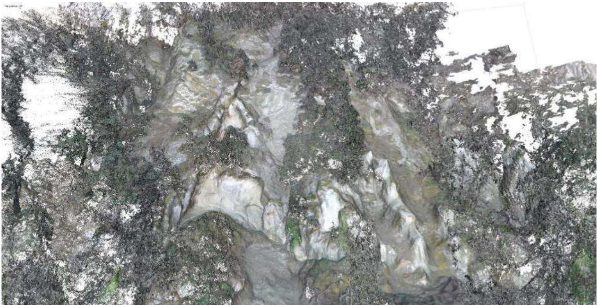
Figura 5.1.4. Nuvola di punti derivata dall'elaborazione fotogrammetrica delle immagini acquisite attraverso aeromobile a pilotaggio remoto: prospettiva frontale della scarpata sub-verticale che costituisce il settore centrale della cornice sommitale del Monte Epomeo.
