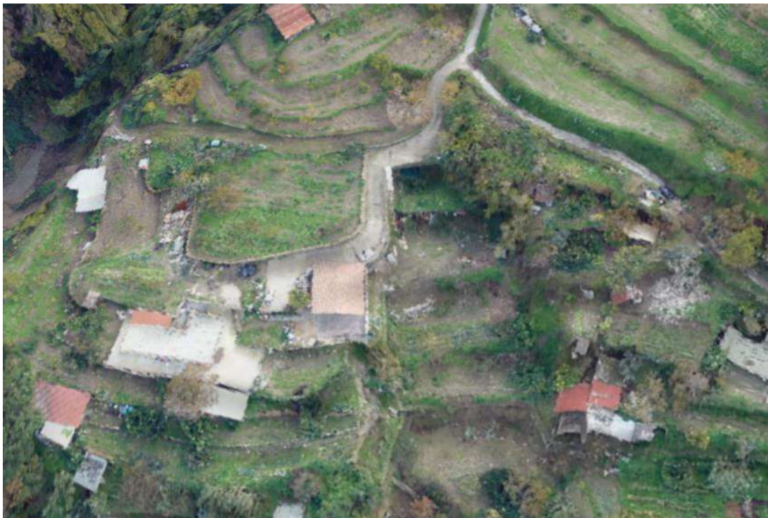
CA_1_F. Dall'analisi storica e delle cartografie prodotte nel dopoguerra emerge la presenza una fonte naturale in corrispondenza delle zone a maggiore altitudine sul livello del mare e il dilavamento della coltre superficiale in corrispondenza dei terrazzamenti.
