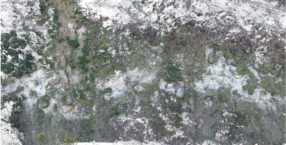
Figura 5.1.3. Nuvola di punti derivata dall'elaborazione fotogrammetrica delle immagini acquisite attraverso aeromobile a pilotaggio remoto: prospettiva frontale della scarpata sub-verticale localizzata a monte dell'area di espansione del flusso all'uscita della "cava" Celario.
