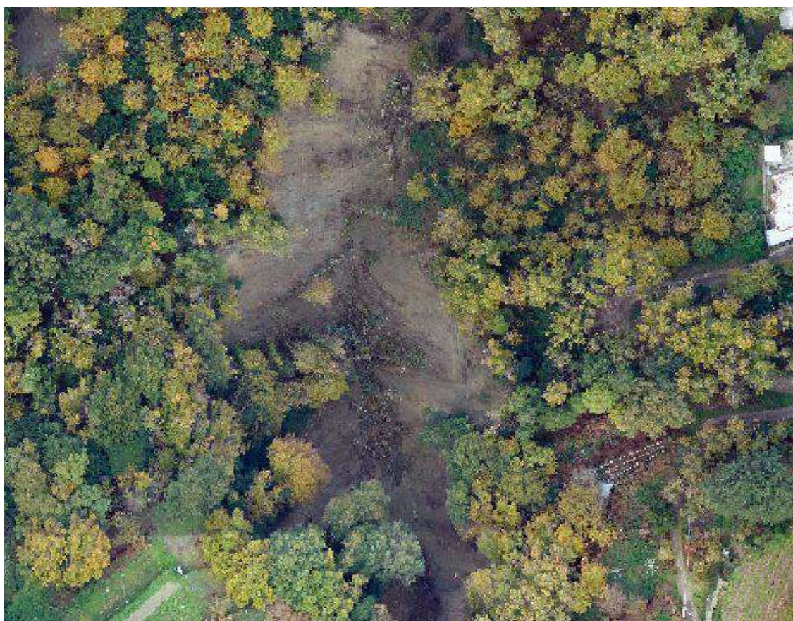
N_3_F. Letto dell'alveo che presenta accumulo di materiale detritico dovuto al trasporto e allo scivolamento dello strato corticale delle pareti acclivi
