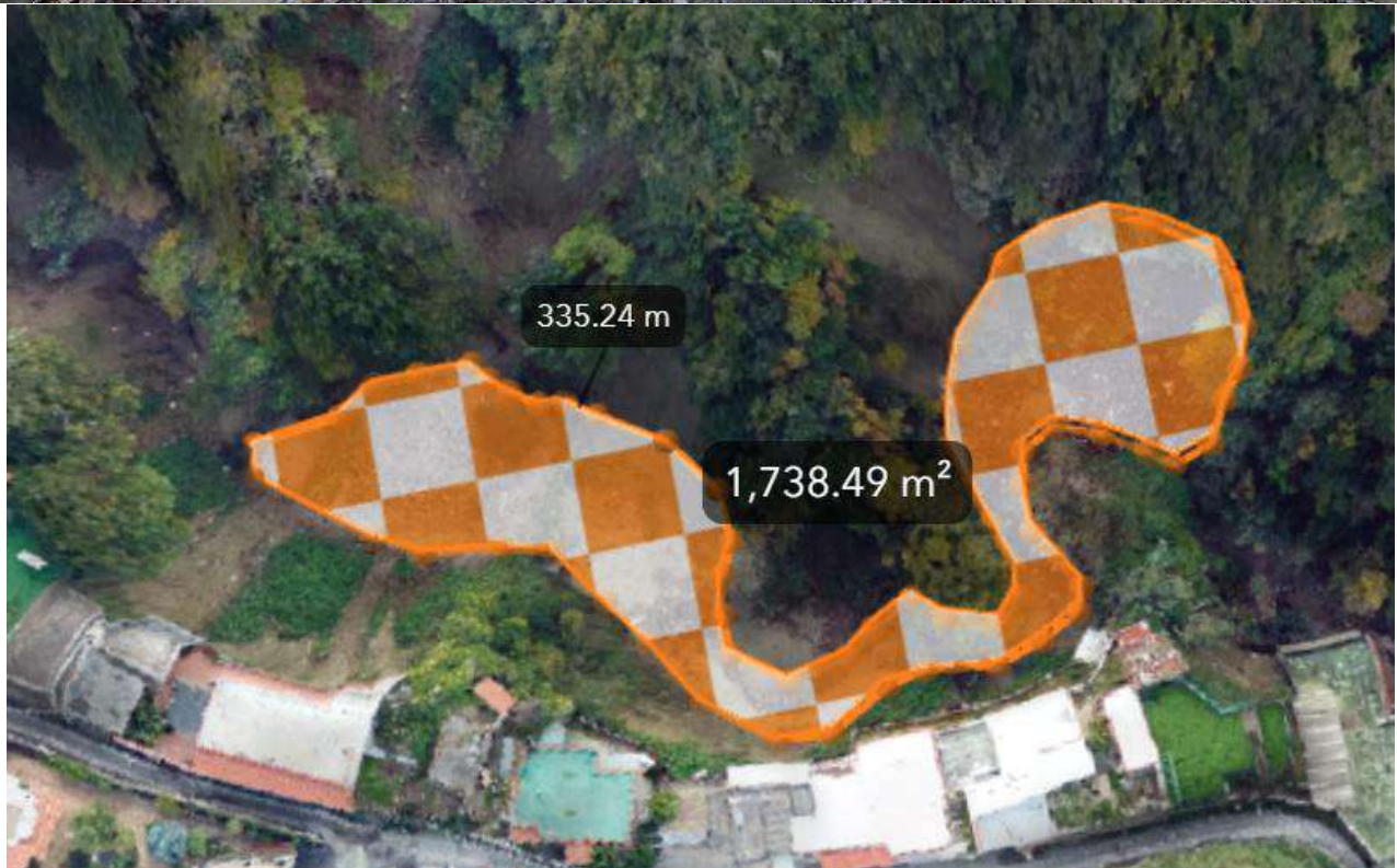
F_19_F. Ampia area di deposito di materiale detritico proveniente dall'alluvione del 2016 e probabilmente da precedenti eventi meteorici di una certa rilevanza. Da testimonianze raccolte durante i sopralluoghi è stata supposta la presenza di una vasca di accumulo per i fanghi. Tuttavia, la tipologia e le dimensioni della vasca non sono note. Dalla stima dello spessore del deposito nella sezione di valle, pari a circa 5 m, si desume un valore di volume accumulato di circa 9000 mc in eccesso.
