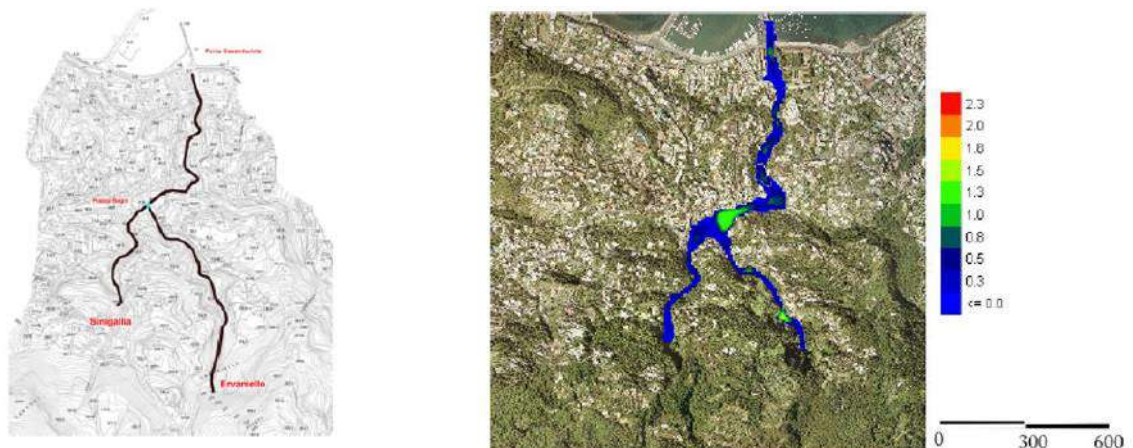
Figura 2.3.6 – Risultati delle modellazioni dell'evento del 10 novembre 2009. A sinistra, punto di massima invasione, alla confluenza tra i valloni, calcolato con DAN-W. A destra, aree e spessori di invasione (in m) calcolati con FLO-2D (Calcaterra et al., 2010).
