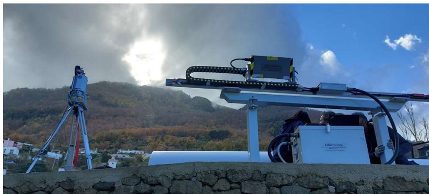
Figura 9. Stazione di rilievo del fronte di Frana UNIFI
