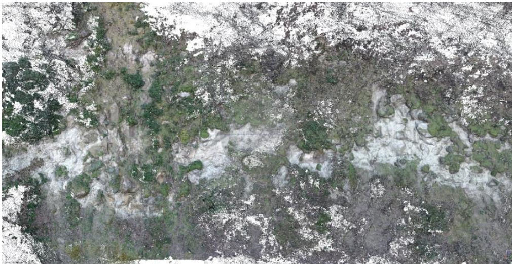
Figura 0.30. Nuvola di punti derivata dall'elaborazione fotogrammetrica delle immagini acquisite attraverso aeromobile a pilotaggio remoto: prospettiva frontale della scarpata sub-verticale localizzata a monte dell'area di espansione del flusso all'uscita della "cava" Celario.
