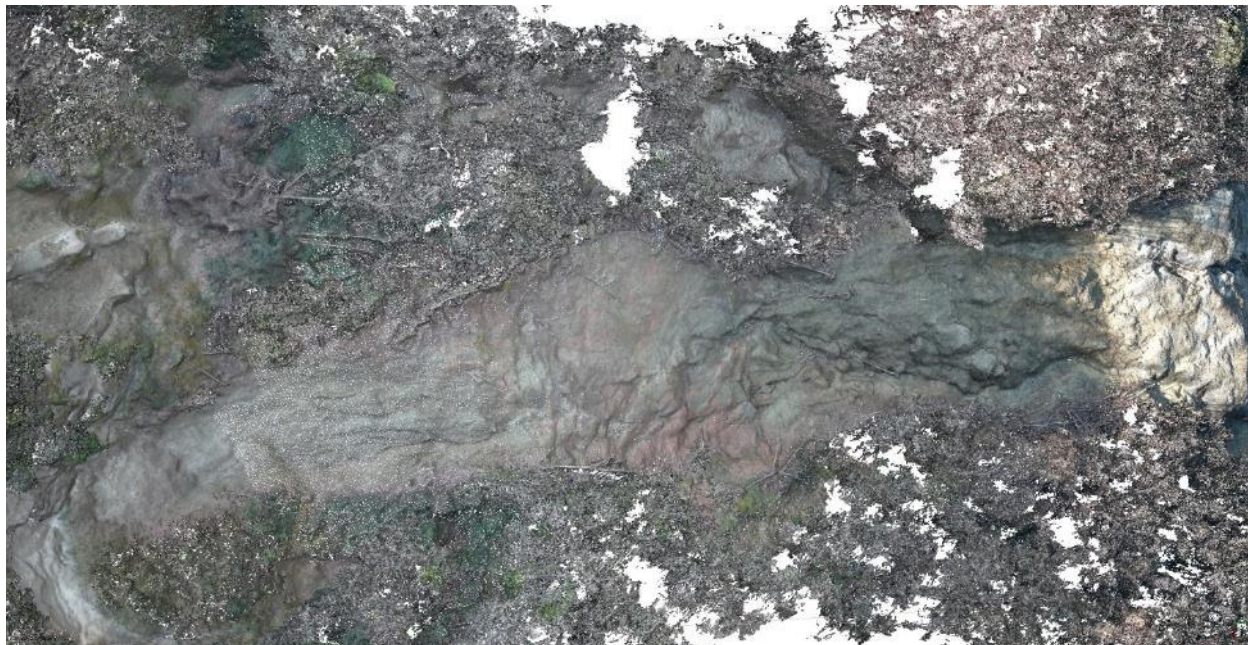
Figura 0.29. Nuvola di punti derivata dall'elaborazione fotogrammetrica delle immagini acquisite attraverso aeromobile a pilotaggio remoto: prospettiva nadirale sull'area di distacco della frana principale in località Celario.
