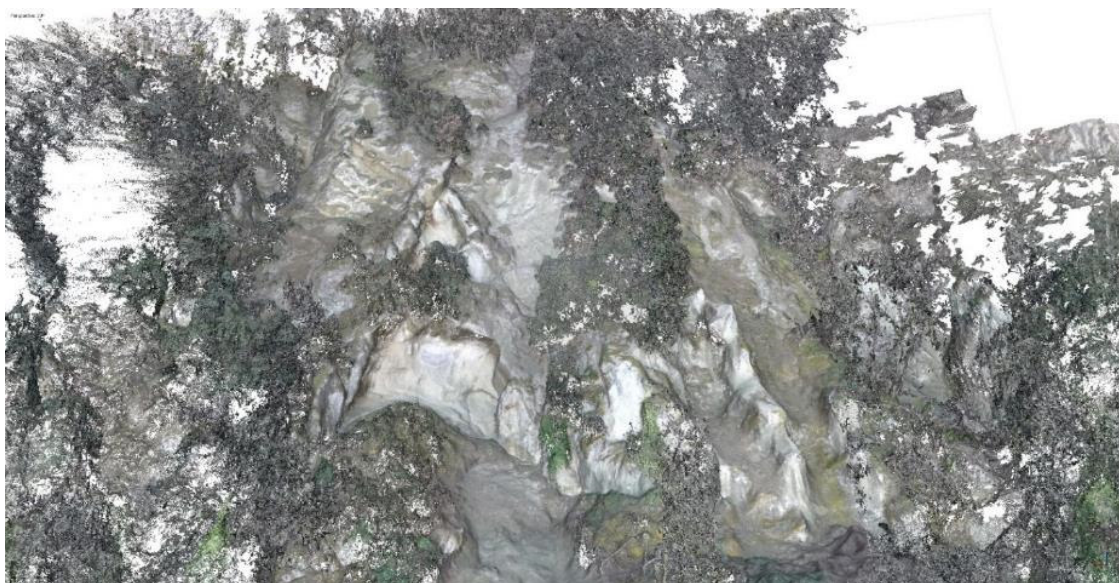
Figura 0.31. Nuvola di punti derivata dall'elaborazione fotogrammetrica delle immagini acquisite attraverso aeromobile a pilotaggio remoto: prospettiva frontale della scarpata sub-verticale che costituisce il settore centrale della cornice sommitale del Monte Epomeo.
