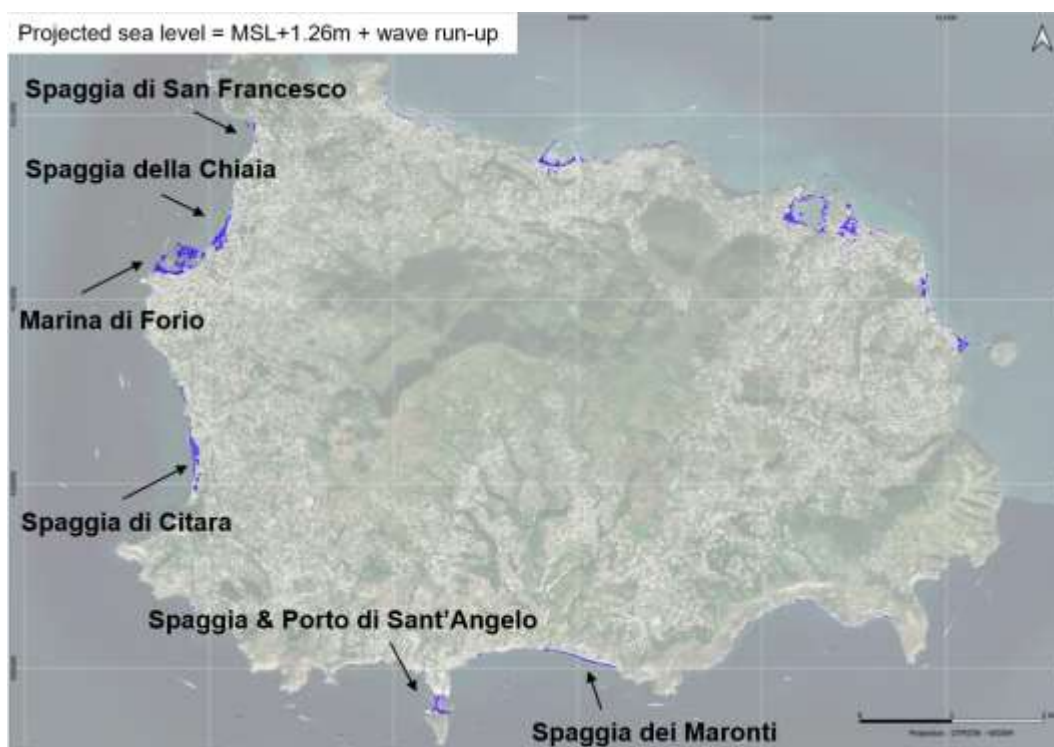
Figura 3-18: Mappa dell'inondazione costiera dell'area bassa per un livello del mare previsto di MSL+1,26m + wave run-up = 2,26m.
