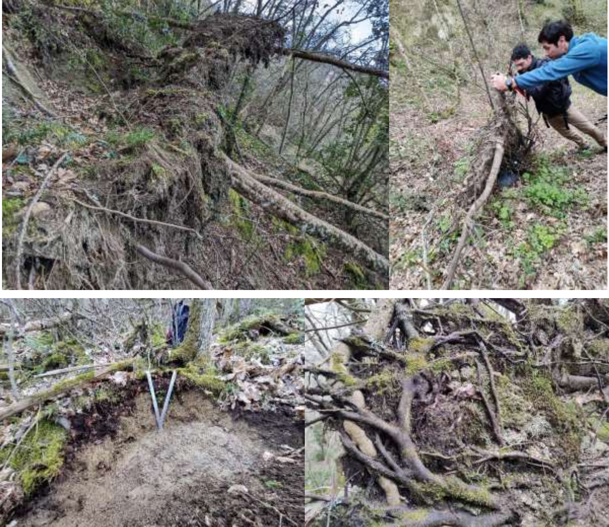
Figura 3-58. Esempi di frassino e castagno sradicati, che evidenziano un apparato radicale poco profondo e atrofizzato. In basso a sinistra, la profondità del suolo misurata è di circa 30 cm.
