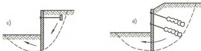
Figura 53. Possibili esempi di instabilità globale di una paratia tirantata
